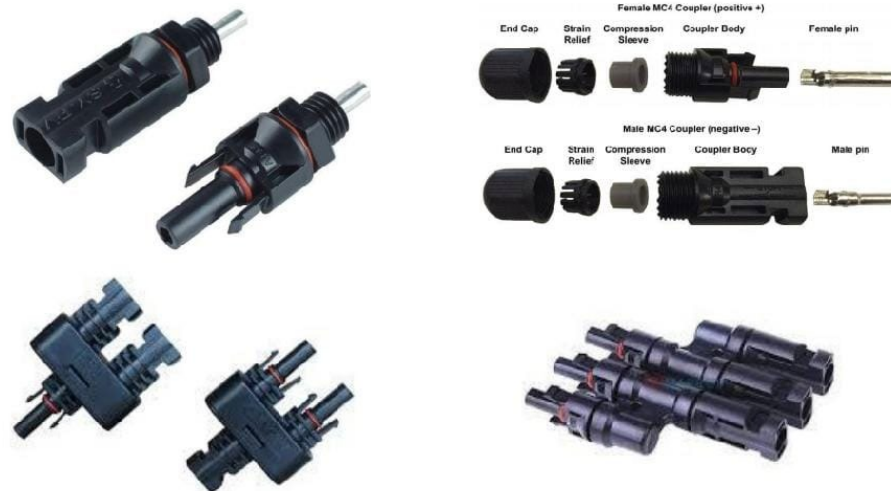
Figura 7 Conectores MC4 macho y hembra, armados para su uso. Despiece de conectores y accesorios para conectar en serie y paralelo de varias filas o strings.
