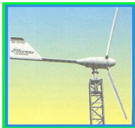
Figura 4.24 Aerogenerador con veleta para su orientación.
