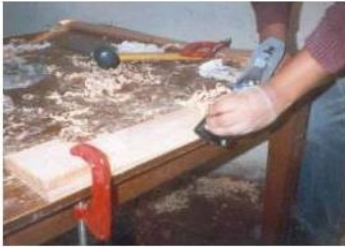
Figura 4.27. Cepillado de desbaste del alabe
