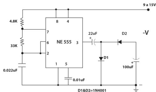
Figura 3. Circuito inversor de voltaje
