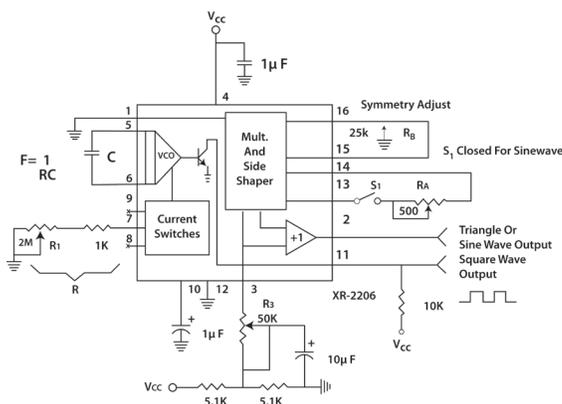
Figura 2. Circuito generador de ondas
