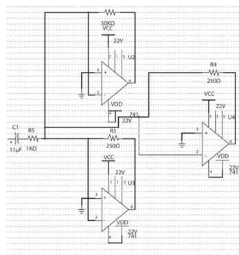
Figura 4. Circuito de amplificación de las señales
