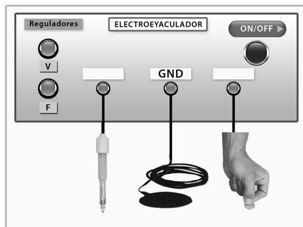
Figura 9. Prototipo de la cara de enfrente del chasis, es decir del panel de control del electro-eyaculador.
