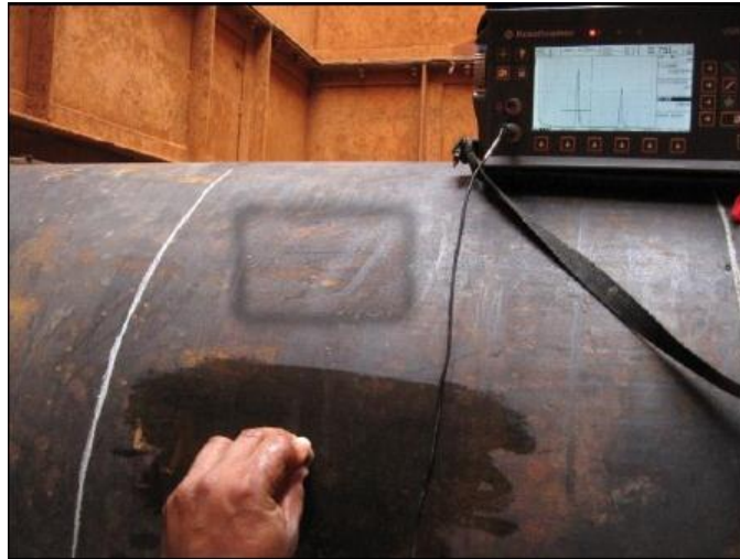
Figura 15. Inspección mediante ultrasonido industrial con haz recto. Fuente Elaboración propia.
