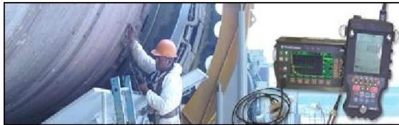
Figura 11. Equipo de ultrasonografía industrial. Fuente: elaboración propia.
