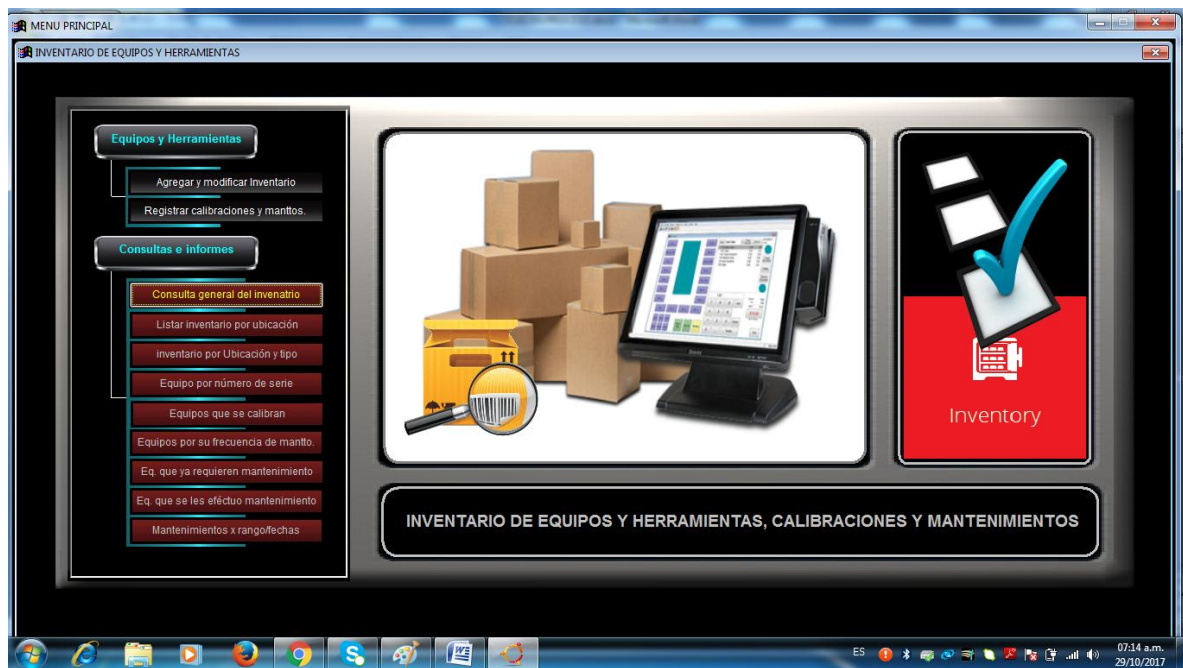
Figura 34. Pantalla de inventario de equipos y herramientas de software de mantenimiento. Fuente: Manual de Procedimientos logísticos para el abastecimiento y mantenimiento aeronáutico, Centro de Educación e Instrucción Militar Aeronáutico.
