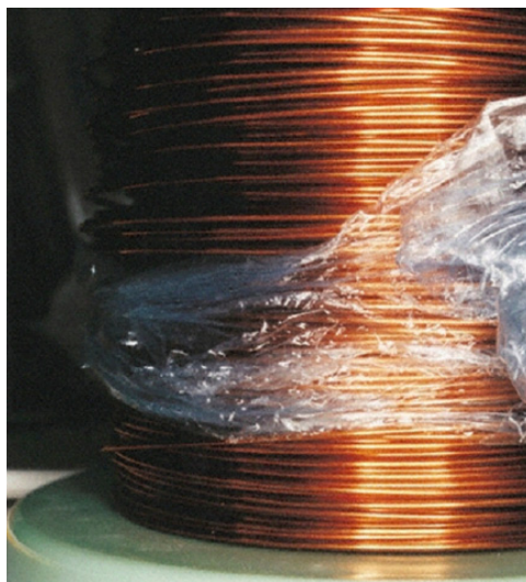
Fig. 3.12 Cable de Cobre libre de cubierta, barniz natural para uso industrial.
