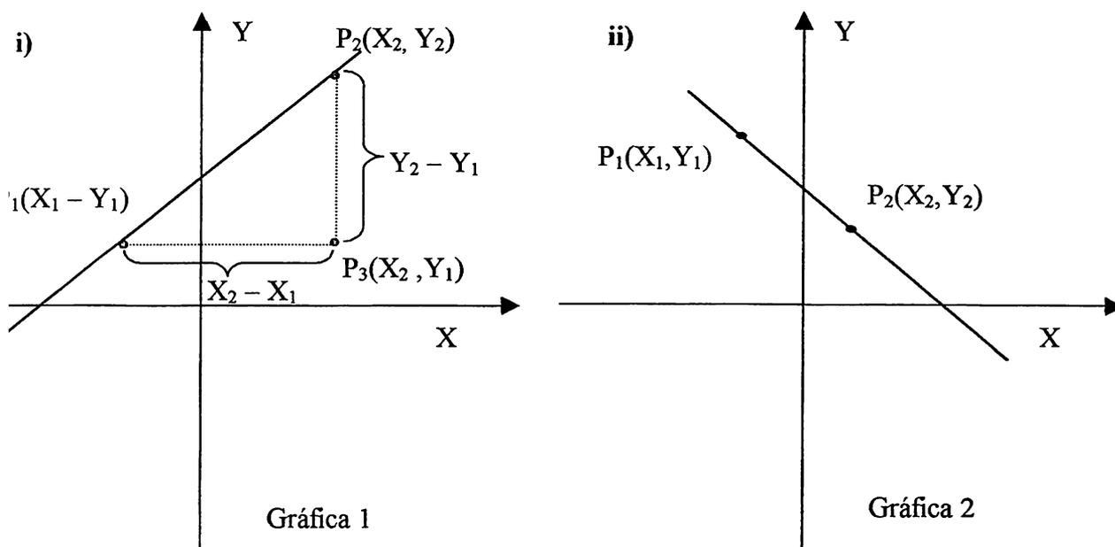
Una recta horizontal es una paralela al eje X. Nótese que una recta es horizontal si y sólo si su pendiente es cero. Una recta vertical es una paralela al eje Y. La pendiente de una recta vertical no esta definida.
