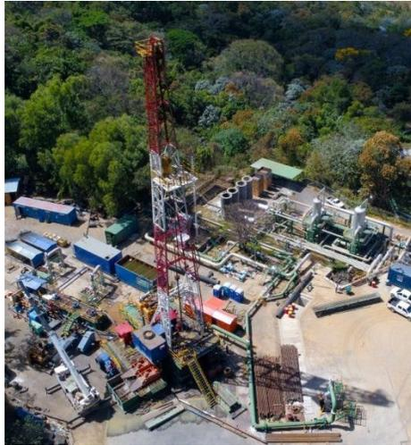
Figura 26. Torre de perforación. [Fuente: <https://twitter.com/LaGeoSV/status/1376672265014759429/photo/4>]
