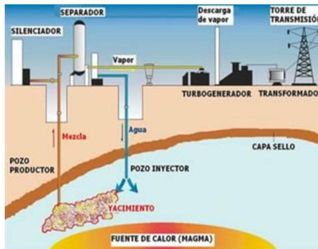
Figura 29. Pozos para extracción de vapor y reinyección. [Fuente: <https://www.monografias.com/trabajos109/energia-geotermica-estudio-caso/energia-geotermica-estudio-caso.shtml>]
