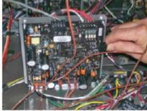
2. Desconecte los bornes del motor del mazo de cables.
