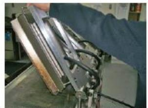
4. Con el peso de la plancha apoyado sobre el objeto que haya insertado en el paso 3, utilice unos alicates para sacar el clip de retención del pasador de horquilla, asegurándose de sujetarlo lo más cerca posible del pasador como le resulte posible para no deformarlo.
