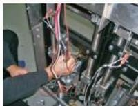
8. Apoye el peso de la plancha mientras retira la palanca. Posteriormente, haga descender cuidadosamente la plancha hasta la posición baja, apoyándola sobre la plancha de la parrilla.
