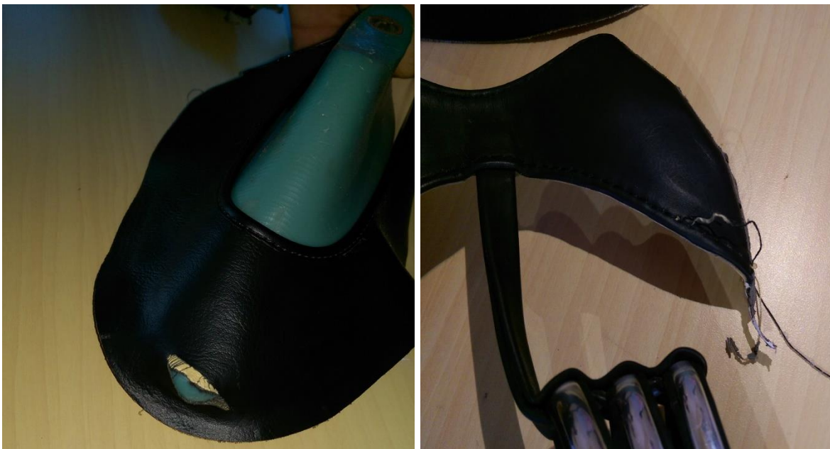
Fig. 24 Problemas ocasionados por máquina de montado y cosedoras.
