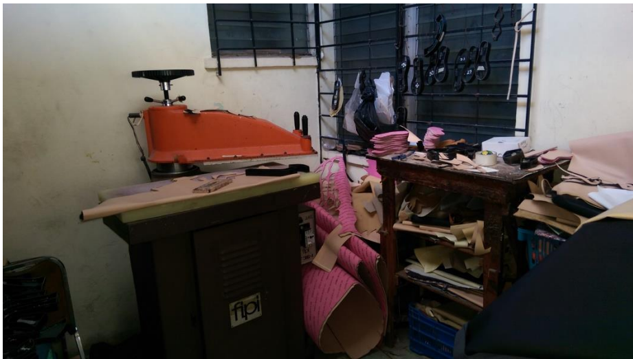
Fig.17. Estación de trabajo de la troqueladora
