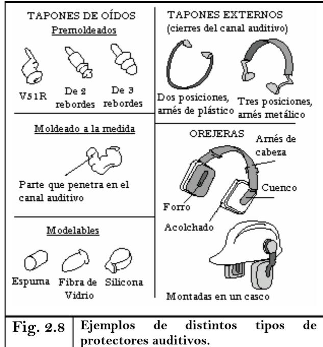
**Fig. 2.8** Ejemplos de distintos tipos de protectores auditivos.
