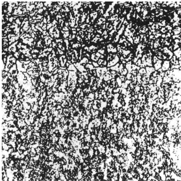
Fig. 5.23 AISI H 13, tratado con "TUFFTRIDE" ( 570°C por espacio de 2 horas )
