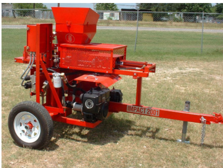
Figura 30. Máquina de compactación hidráulica Impacto 2001A 11
