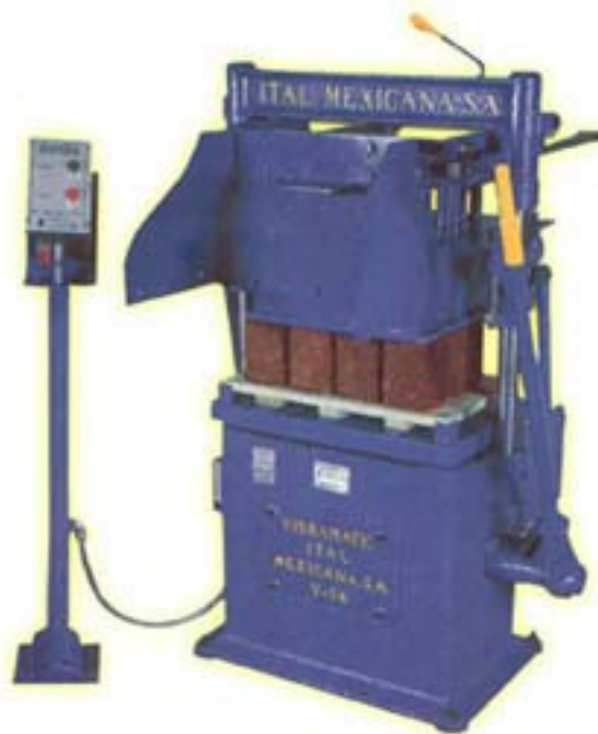
Figura 26. Máquina de vibrocompactación Vibramatic V/56 5
