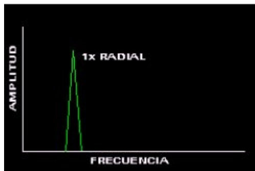
Figura 91. Espectro de holgura de fatiga estructural
