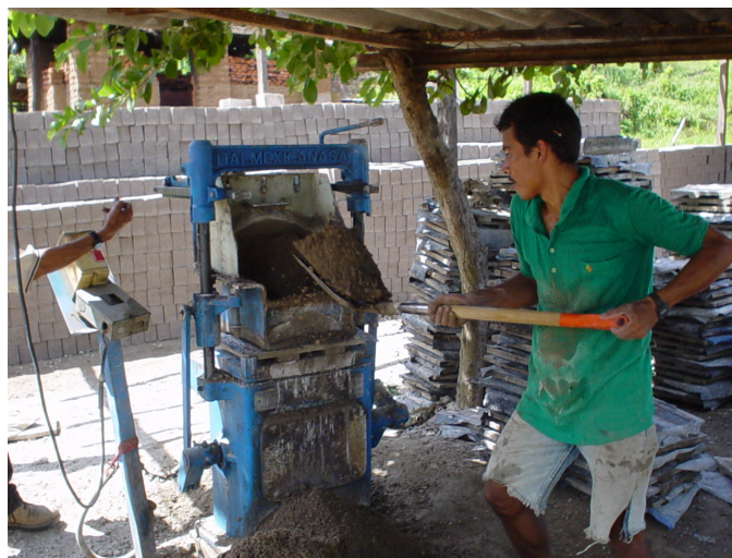
Figura 21. Llenado de la tolva alimentadora con la mezcla
