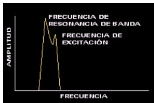
Figura 106. Espectro de resonancia de banda
