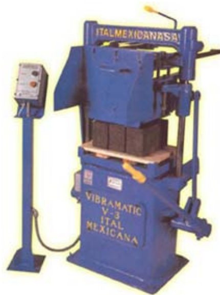
Figura 25. Máquina de vibrocompactación Vibramatic V/3 3
