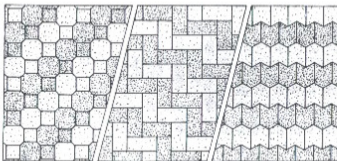
Figura 6. Diferentes diseños de adoquines de concreto
