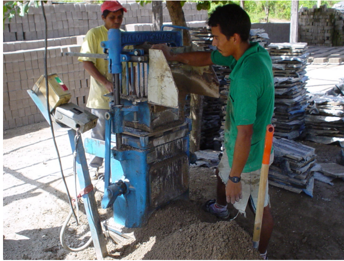
Figura 22. Movimiento de la tolva alimentadora
