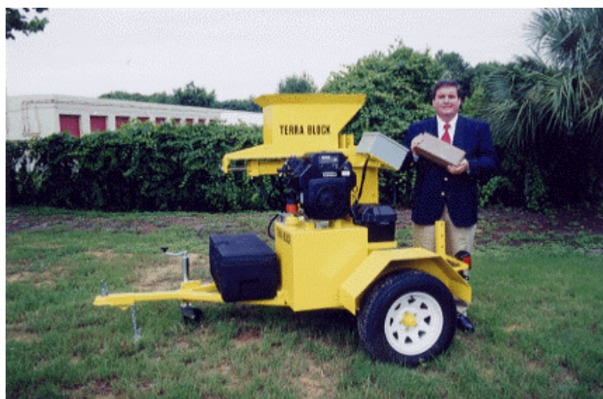
Figura 27. Máquina de compactación hidráulica Terra-250A 7
