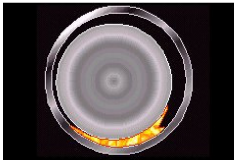
Figura 109. Vibración de chumaceras por remolino de aceite
