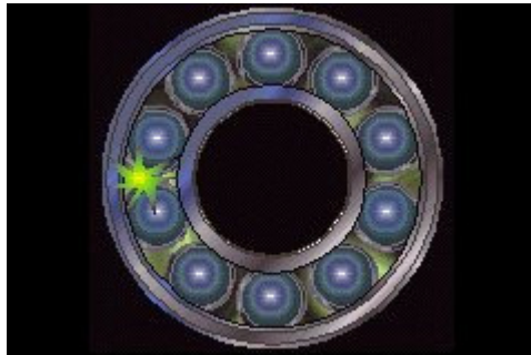
Figura 119. Deterioro de jaula en un rodamiento
