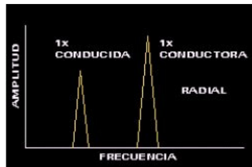
Figura 104. Espectro de excentricidad de poleas
