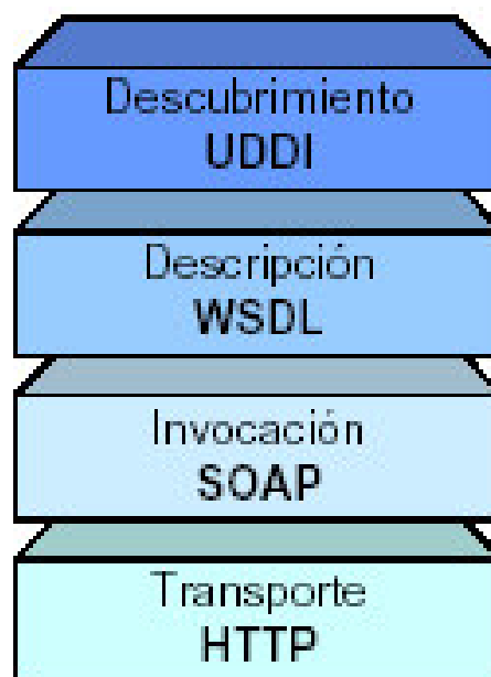
Figura 5. Capas de estructura de Web Services.
