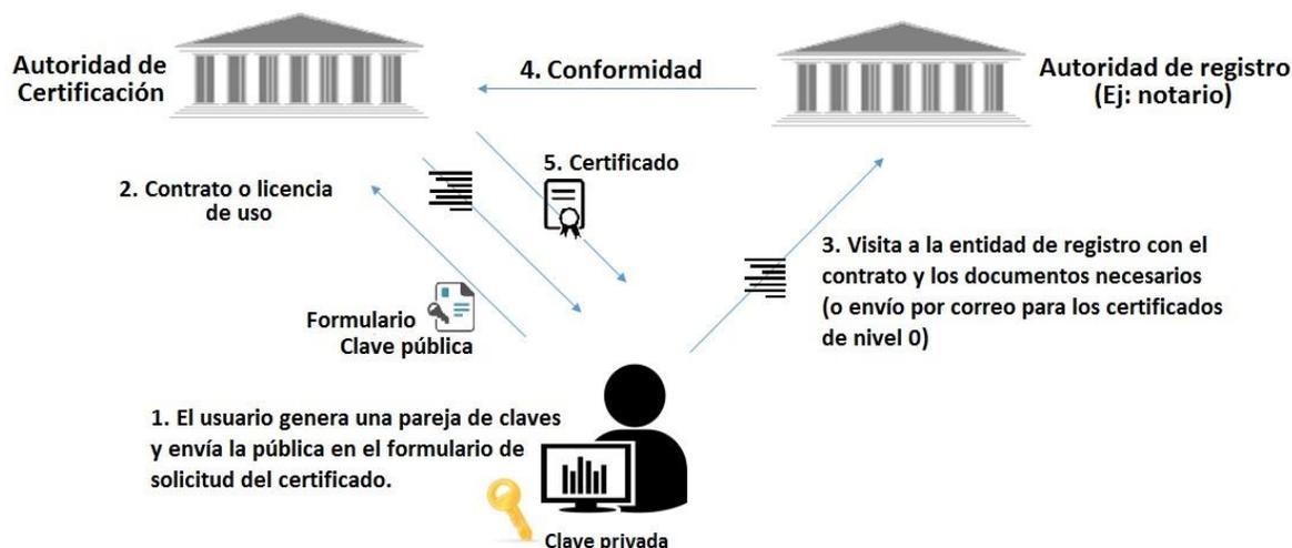
Fig. 5. Funcionamiento de la estructura de llave pública [12].
