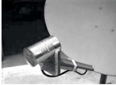
Figura 27 muestra una Antena bocina hecha con una lata de comida.
