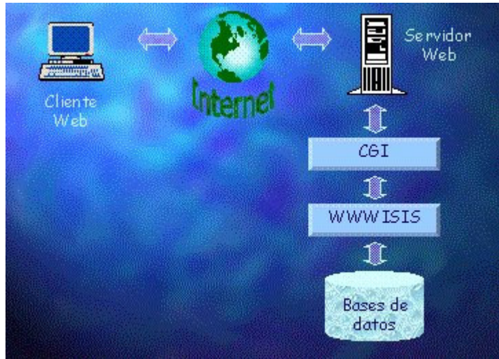
Figura 40 Ejemplo de funcionamiento de plataforma Web
