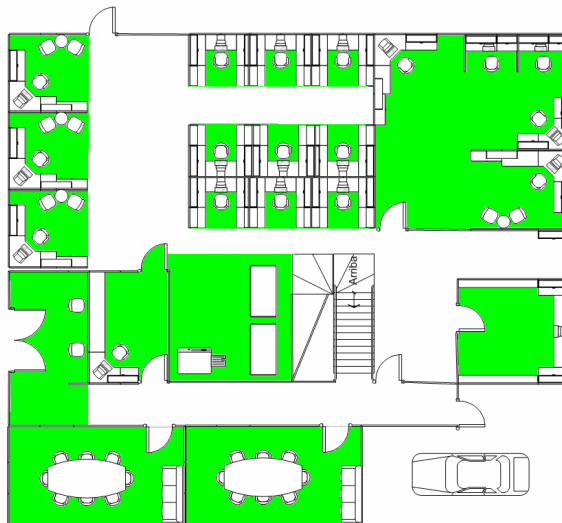
Figura 49 Cobertura Access Point 7250
