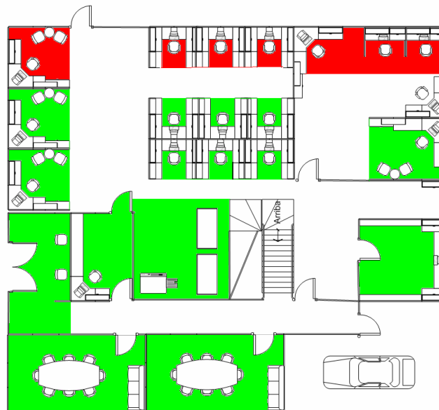
Figura 51 Cobertura Access Point WAP54G
