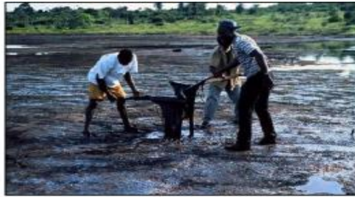
Figura 12: Extracción del asfalto en estado natural Fuente: Elaboración propia
