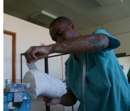
Imagen 11: desbastando el exceso de yeso
