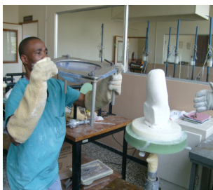
Imágenes 15, 16, y 17: imagen en el proceso de termo conformado en gota.
