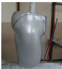
Imágenes 15, 16, y 17: imagen en el proceso de termo conformado en gota.
