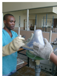
Imágenes 15, 16, y 17: imagen en el proceso de termo conformado en gota.
