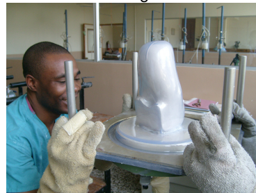
Imágenes 15, 16, y 17: imagen en el proceso de termo conformado en gota.
