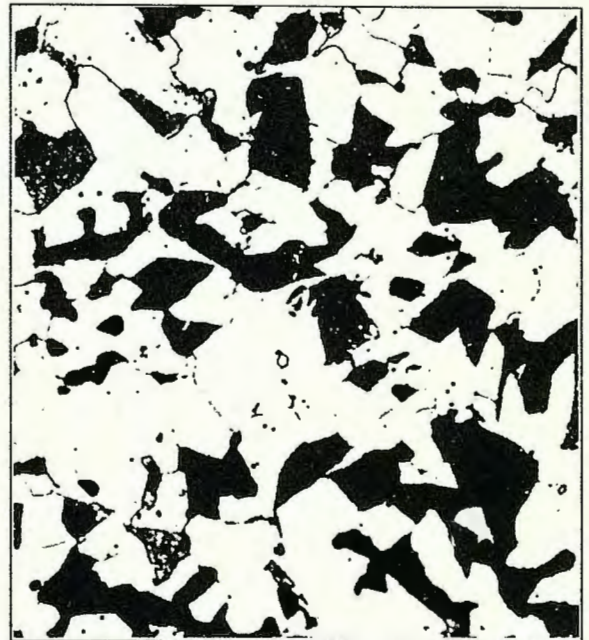
Fig. 1.3 Acero hipoeutectoide (SAE 1020). Magnificación 500x.
