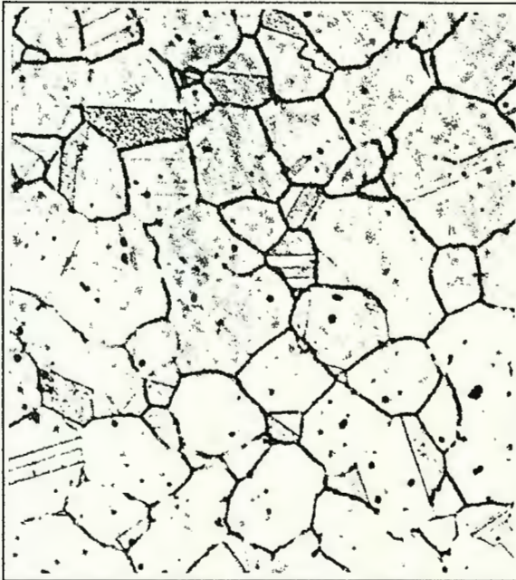
Fig. 1.2 Fotomicrografía de un acero inoxidable austenítico SAE 316. Aumento 115x.
