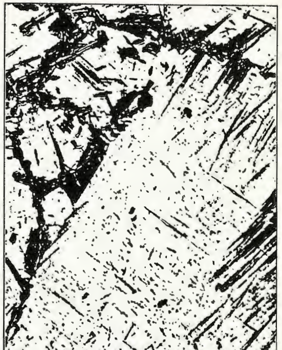
Fig. 1.15 Acero SAE 1040 austenitizado a 1200°C y templado en agua y hielo. Las zonas que aparecen claras son martensita; las agujas oscuras son bainita inferior. Aumento 500x.
