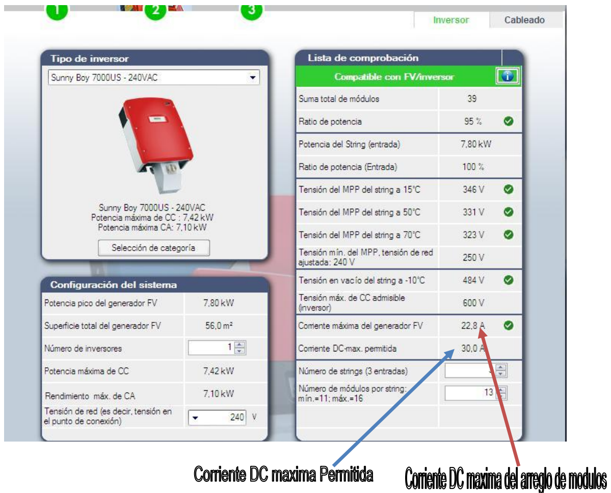
Figura 3.28 Corriente máximas para el edificio R
