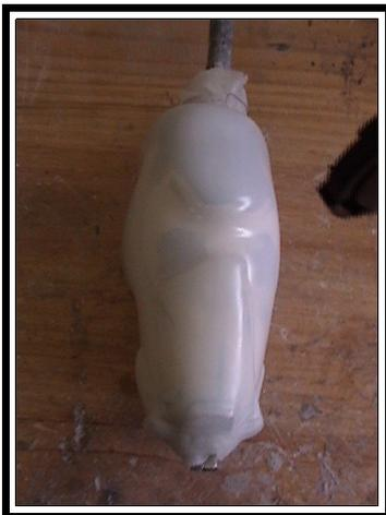
Molde positivo termoconformado
