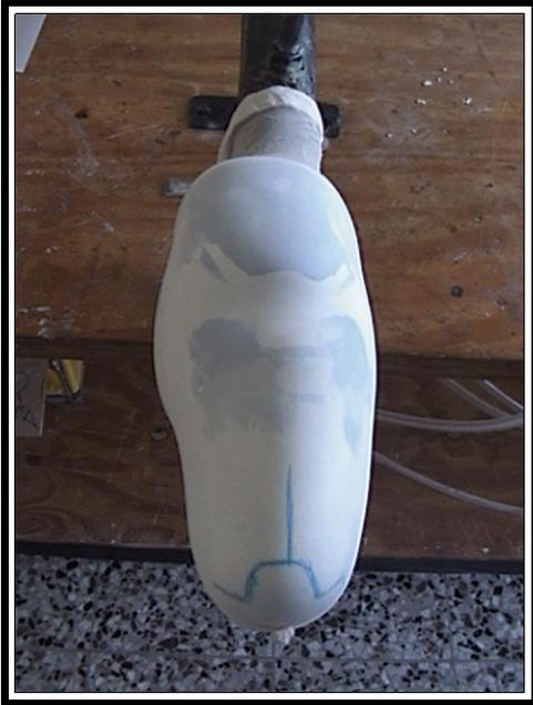
Molde positivo en el sistema de termoconformado
