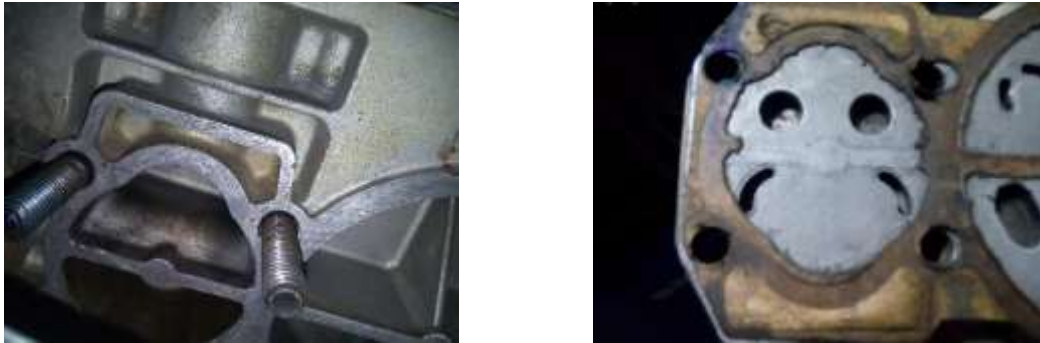
Fig. 1. Vista de las partes del compresor que requieren sistema de empaque.
