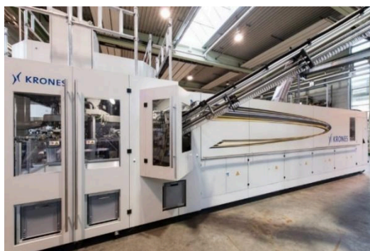
Figura 3-1: Sopladora de botellas PET Krones modelo K12C3.
