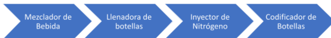
Figura 2-4: Diagrama de Proceso de Proceso de Envasado, sección de Llenado de Botellas.
