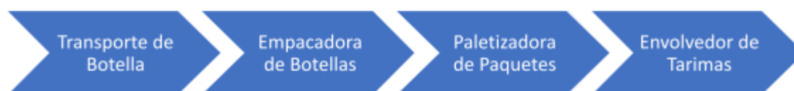
Figura 2-5: Diagrama de Proceso de Proceso de Envasado, sección de Empacado de Botellas
