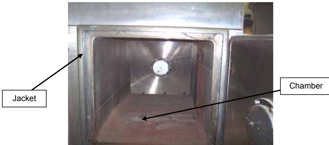
Figura 3.3. Interior del esterilizador, señalización de cámara externa e interna.
