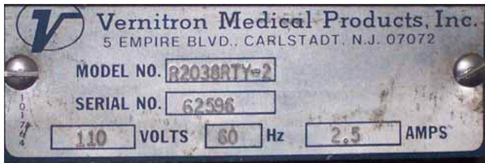
Figura 3.5. Placa de Identificación Parámetros Eléctricos del Equipo.
