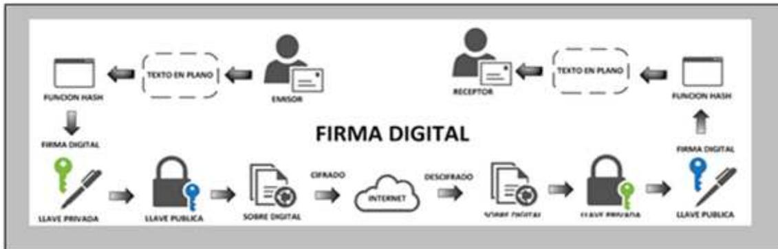
**Figura 4.4.1** Proceso de firma Digital.
