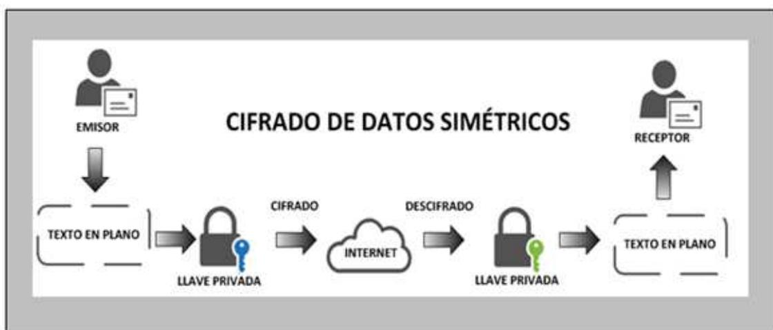
Figura 4.3.1 Proceso de cifrado de datos simétricos.
