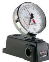
Figura No 24. Dispositivo de calibración de torquímetros
