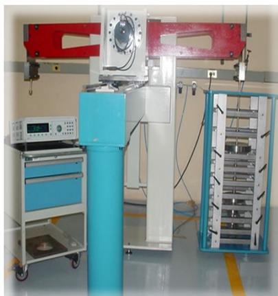
Figura No 14. Patrón primario de par torsional de 2 KN·M
