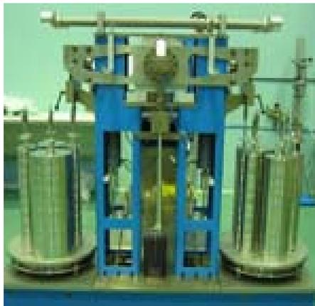
Figura No 18. Máquina patrón de par de carga directa de 1000 N.m
