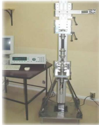
Figura No 16. Patrón de transferencia de par torsional de 20 N·M
