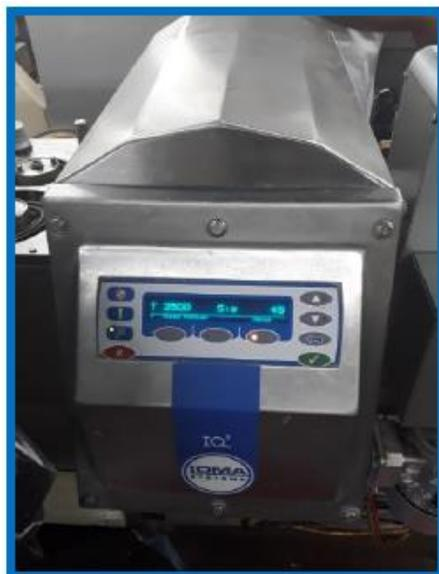
**Figura 13. Detector de metales (Tomada en la fabrica, Junio 2018).**
