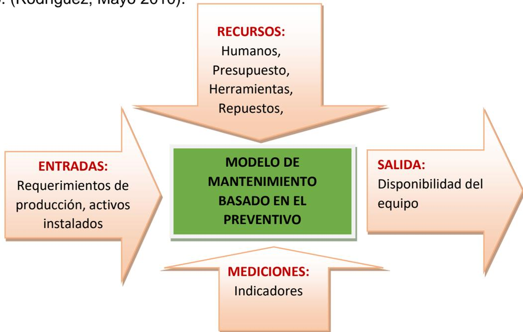
**Figura 24. Entradas y Salidas del modelo de mantenimiento.**
