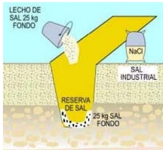
Fig. 4.28 Lecho de sal en fondo de zanja.
