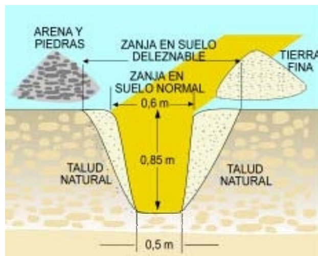
Fig. 4.26 Perfiles de excavación de zanjas.
