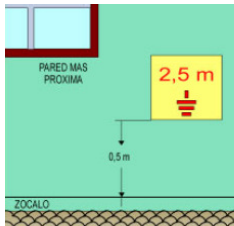
Fig. 5.3 Señalización de la puesta a tierra
