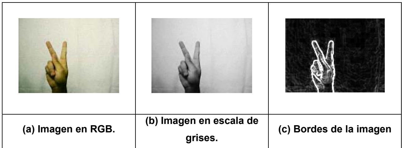
Figura 49.- Proceso de una imagen utilizando detector de bordes Sobel.
