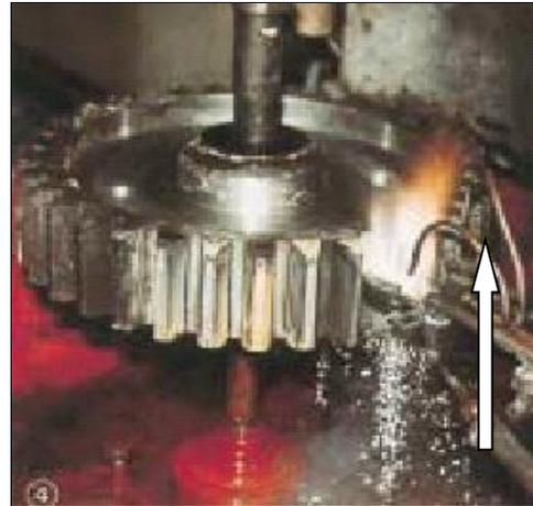
Figura 1.13. Método de calentamiento progresivo.
