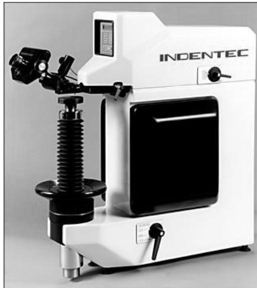
Figura 1.24. Fotográfica de una Máquina de ensayo de dureza universal de palanca <sup>[14]</sup>.
