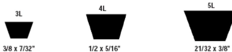
Figura 3.23. Dimensiones características para diferentes tipos de bandas tipo L
