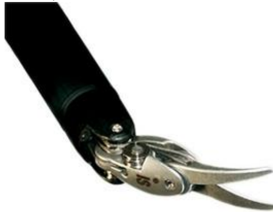
Figura 2-6: Instrumentos Endowrist® Manipulados por los brazos mecánicos
