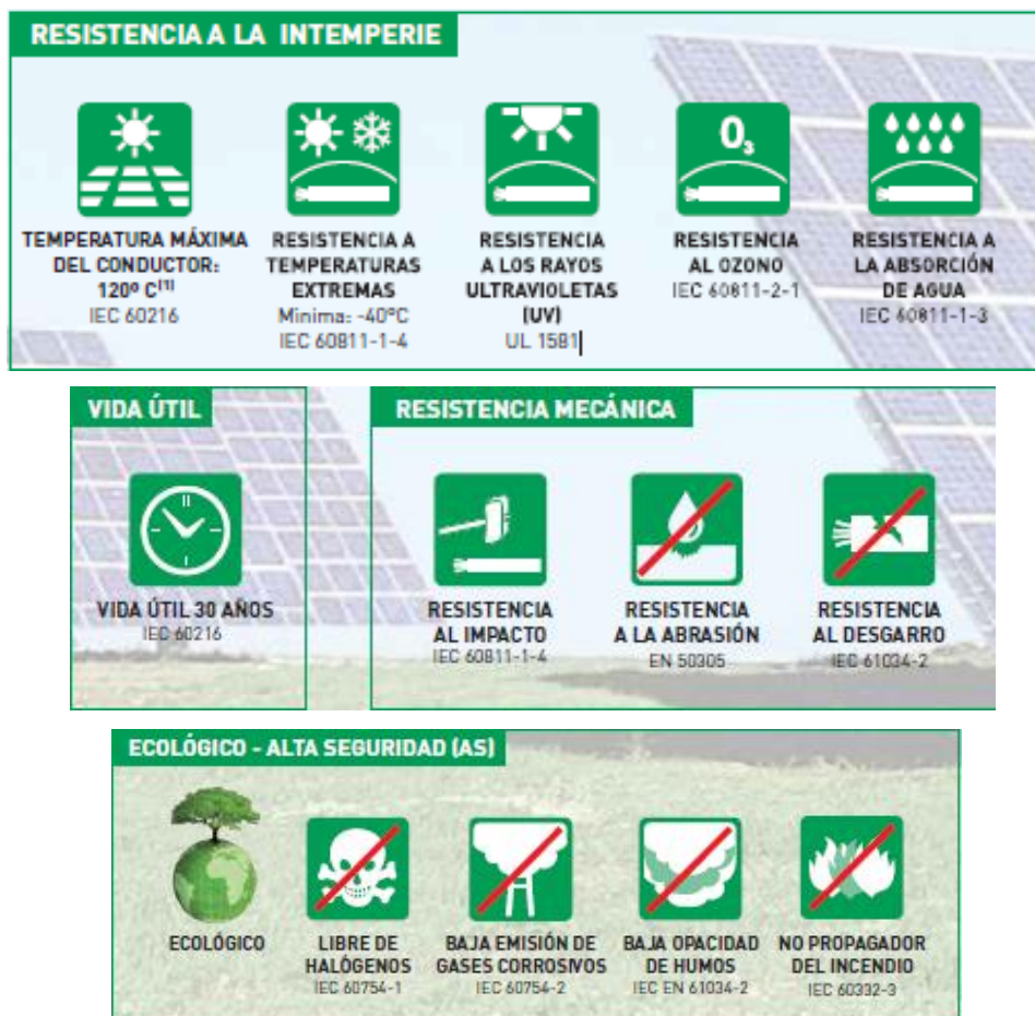
Figura 2.0 Normas IEC y UL para cables FV.
