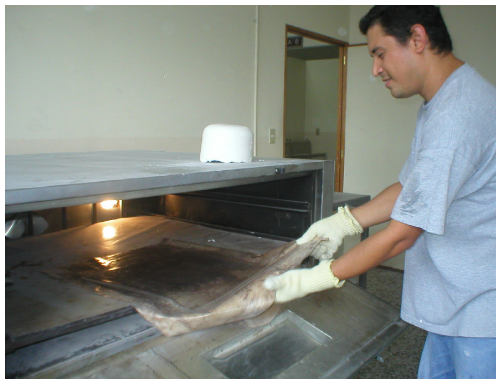
Instante en que el polipropileno es sacado del horno para la termo-conformación del mismo.
