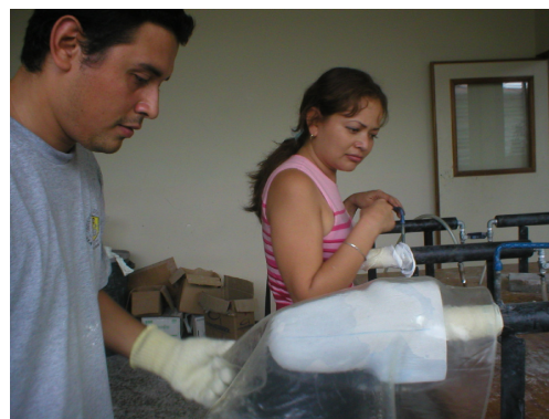
Instante en que el polipropileno es sacado del horno para la termo-conformación del mismo.
