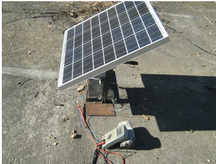
Figura 7.5.d Sistema de Seguimiento
