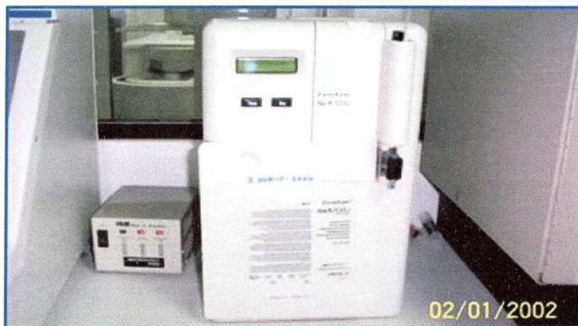
FIG. 2.2.2 Analizador para electrolitos Easy Lyte plus.<sup>6</sup>
