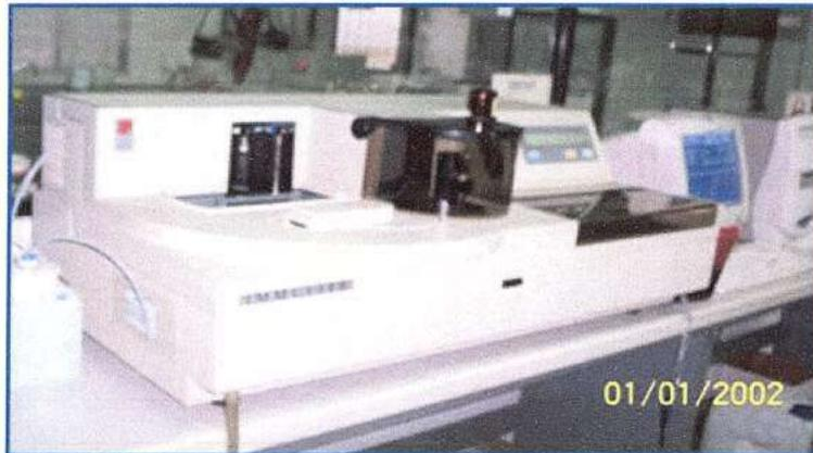
FIG. 2.4.3 El analizador de inmunoensayos automatizado IMMULITE es un instrumento de acceso aleatorio que desarrolla inmunoensayos quimioluminiscentes.<sup>11</sup>
