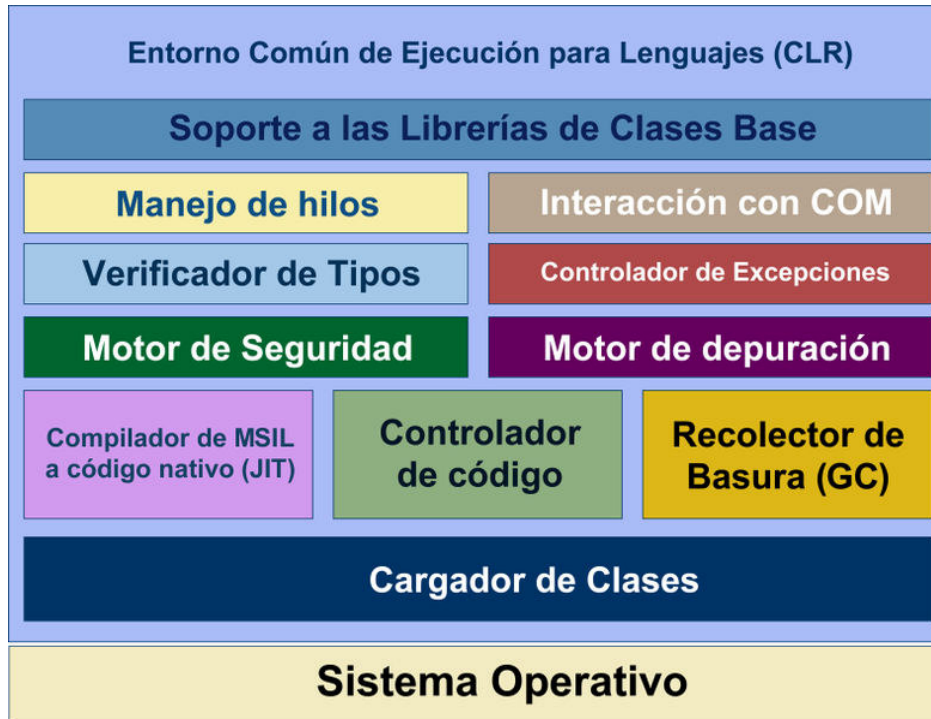
Ilustración 47: Diagrama de la estructura interna del Entorno de Común de Ejecución para Lenguajes (CLR por sus siglas en inglés)
