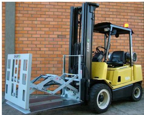
Figura 9. Montacarga para exportación con accesorio “push-pull” o empuje y agarre.
