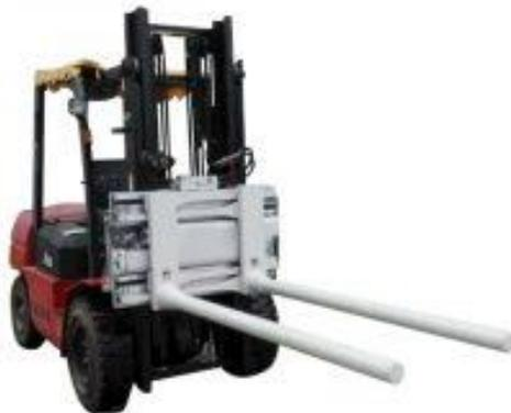
Figura 16. Montacargas de descarga con accesorio de pinza o “*clamp*”.
