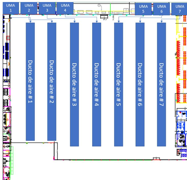
Figura 14. Distribución de Unidades Manejadoras de Aire (UMA) en el piso de producción
