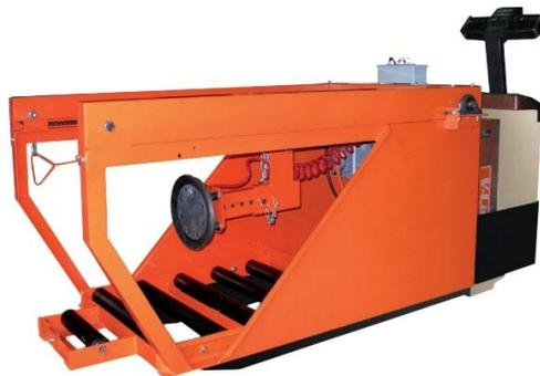
Figura 19. Cambiador de baterías.
