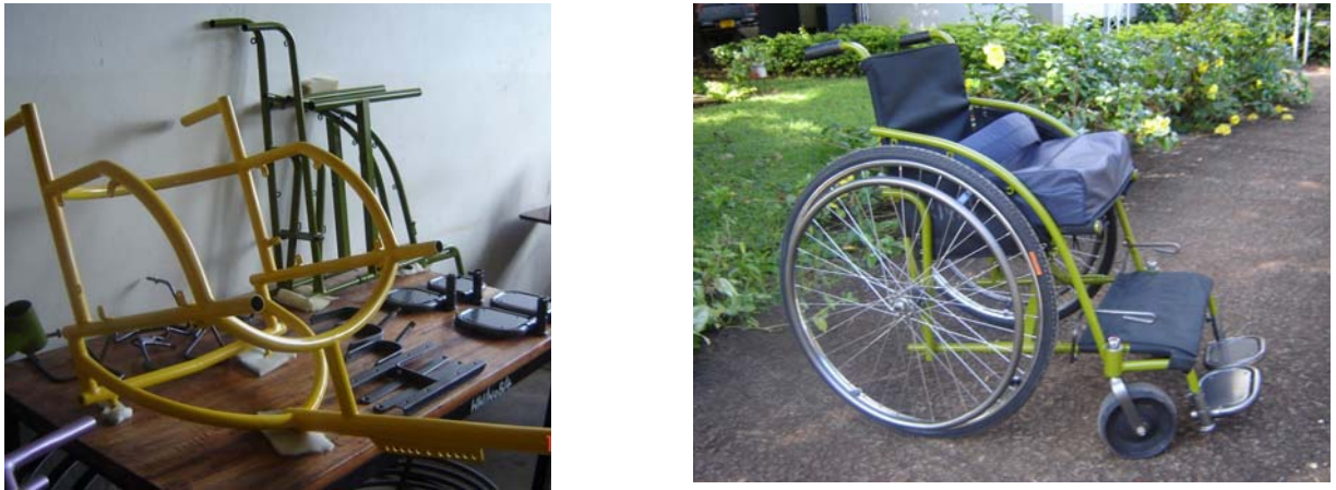
Figura 11. Izquierda Ensamble de piezas de silla de ruedas 4R Y 3R. Derecha- silla 4R terminada
