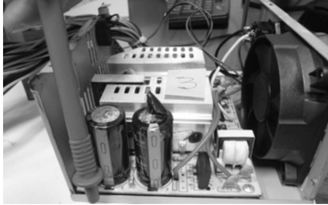
Figura 6. PCB para fuente de computadora tipo clon. 2
