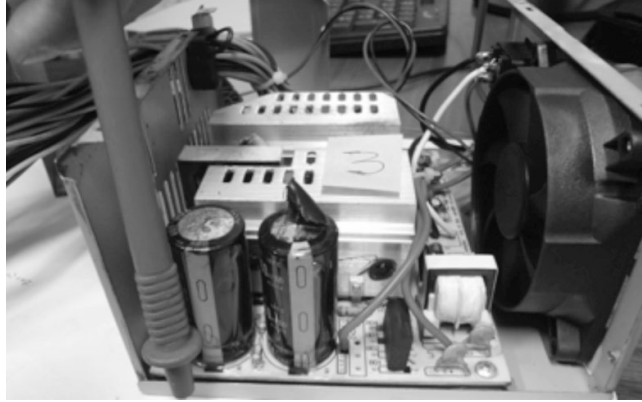
Figura 6. PCB para fuente de computadora tipo clon. 2
