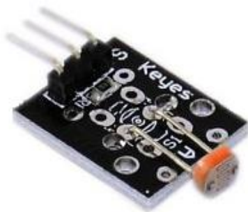
Figura 17. Sensor de Intensidad Luminosa KY-018
