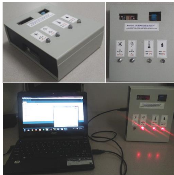
Figura 20. Módulo de Monitorización de Parámetros Ambientales para una UCIN
