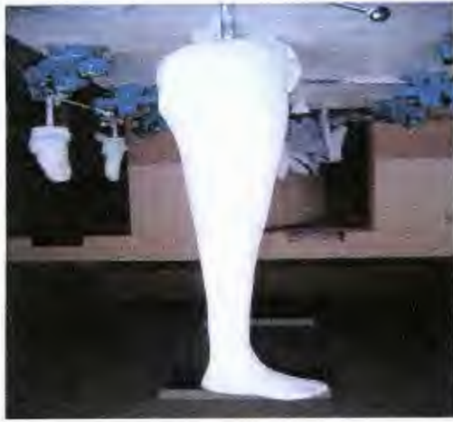
29. Rectificación del molde positivo.
