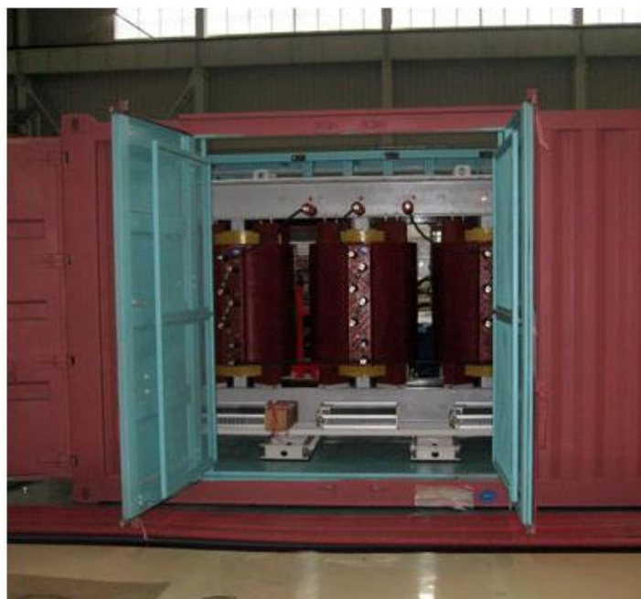
Figura 9. Contenedor de pruebas de funcionamiento de baja tensión LVRT
