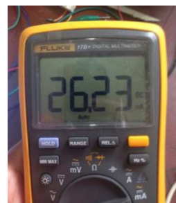
Fig. 9 Resultados de medición de corriente en carga mediante el multímetro.
