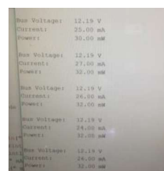
Fig. 10 Resultados de medición de corriente en carga mediante el sensor INA219 mostrado en monitor serie
