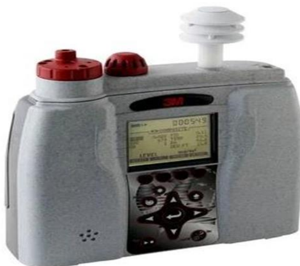
Figura 13: Sensor para la medición de CO 2
