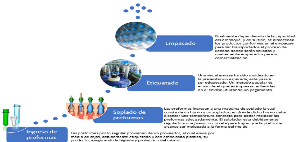
Ilustración 2 Proceso de fabricación de envases PET
