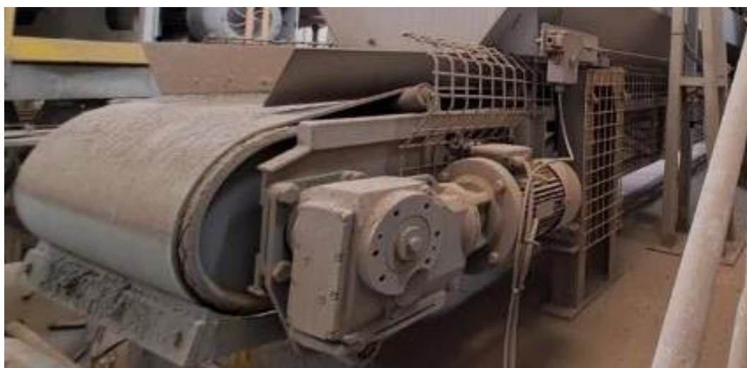
Figura 1.15. Alimentador de pigmentos
