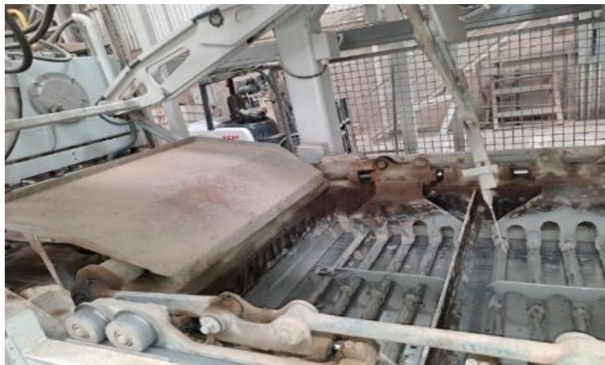
Figura 1.9. Distribuidor de materiales
