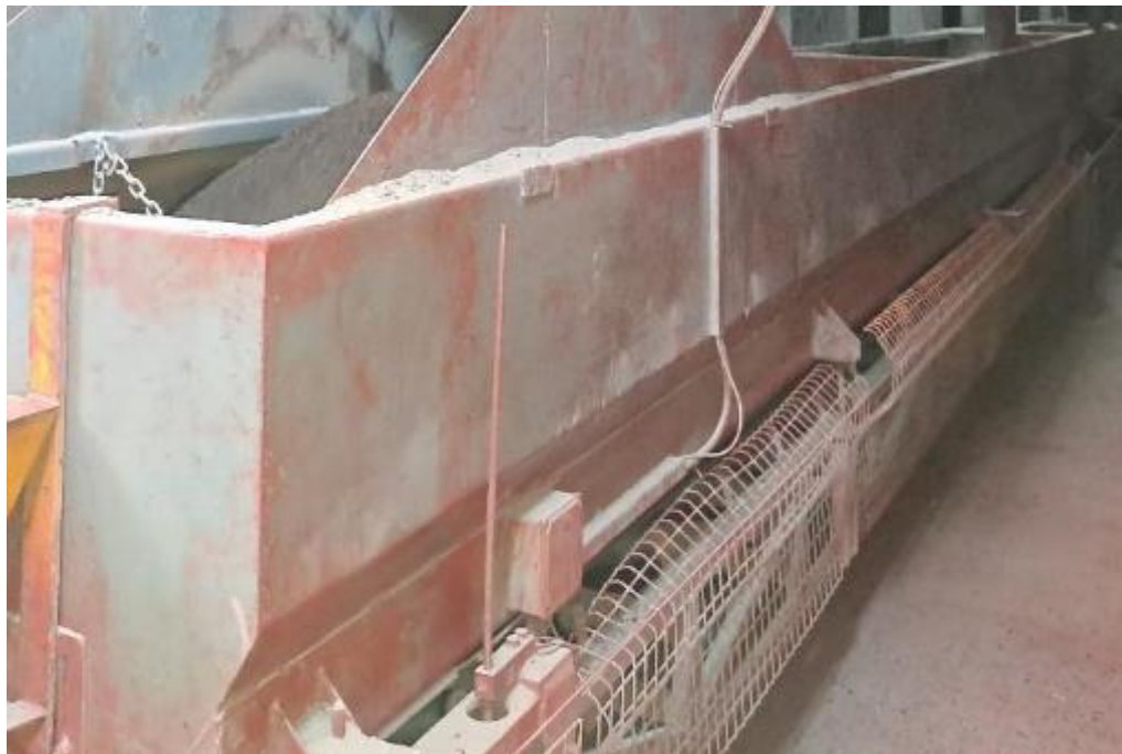
Figura 1.6. Báscula de cemento
