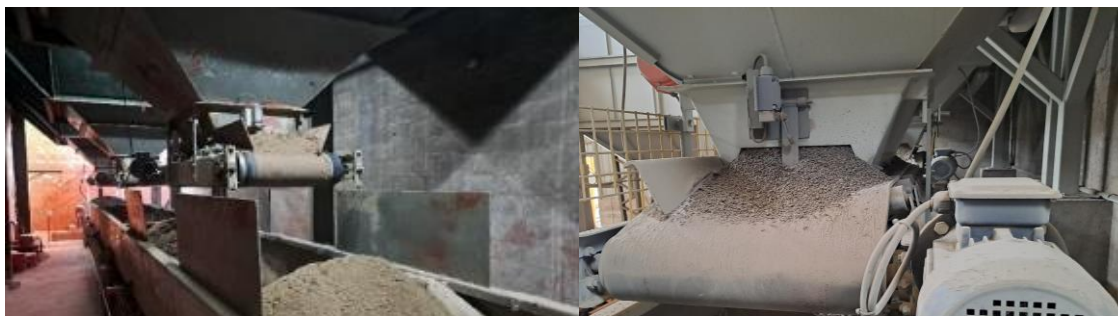
Figura 1.3. Dosificador de áridos
