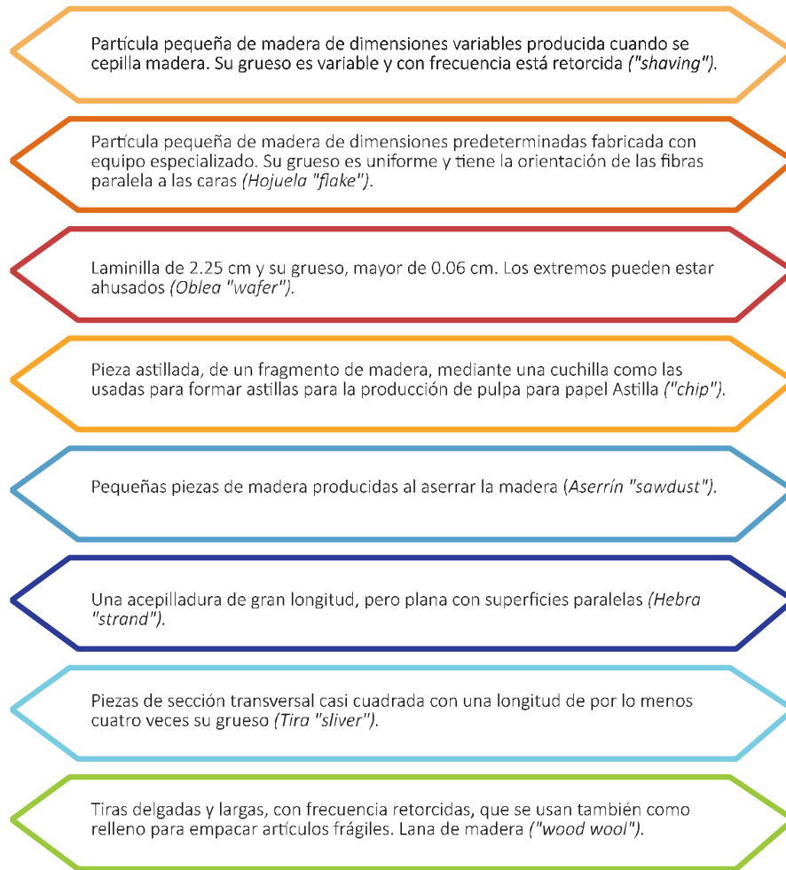
Figura 3. Partículas usadas para la fabricación de tableros. Fuente: Elaboración propia.
