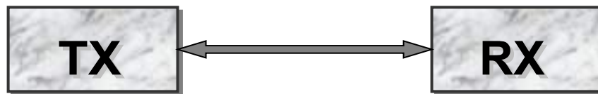
Figura 4.2 Circuito de Transmisión Semiduplex.
