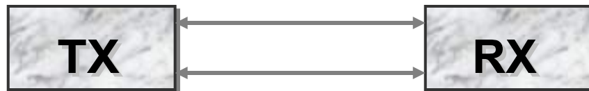
Figura 4.3 Circuito de Transmisión Fullduplex.
