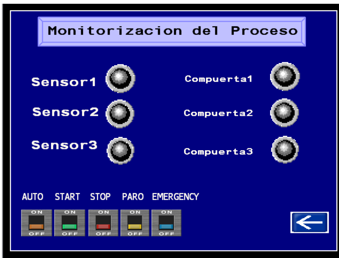
FIGURA 27. PANTALLA DE MONITORIZACIÓN.
