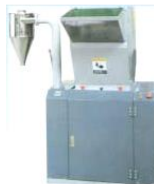
Figura 13. Molino de 300 HP rotor Abierto o cerrado
