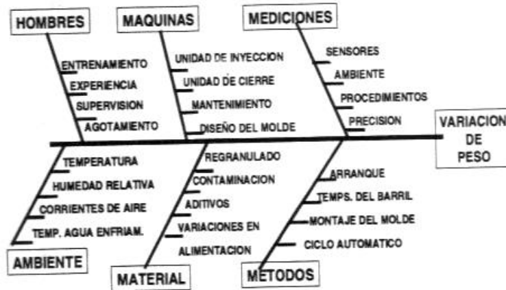
Figura 32 : Ejemplo de Diagrama Causa Efecto Aplicado a Inyección
