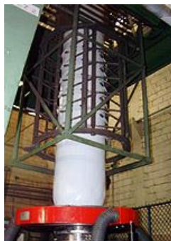
Figura 4. Extrusión de plástico para la fabricación de Bolsas en IPSA S.A de C: V.
