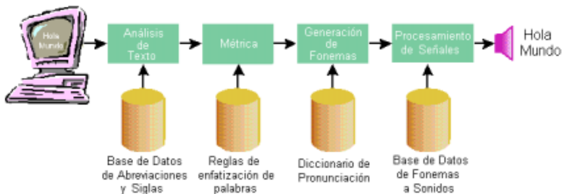
Figura 4.4 Arquitectura de un Motor TTS
